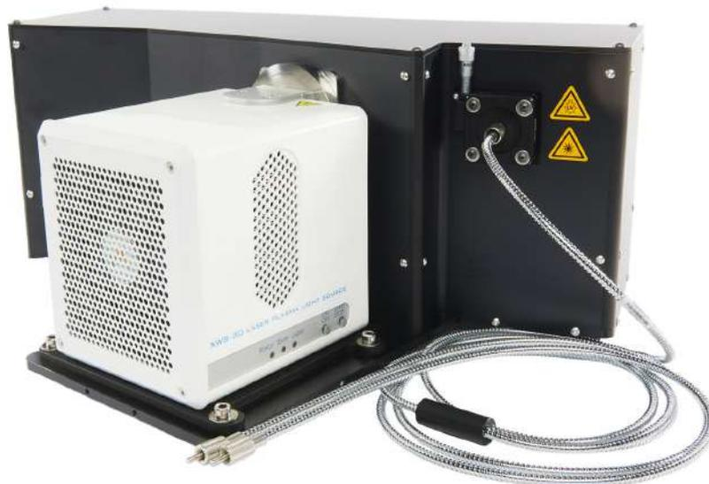
La résolution spectrale est de 1 à 10 nm suivant le choix du réseau et la puissance obtenue en sortie de fibre est ~ 100  $\mu$ W / nm au pic d'accordabilité avec une fibre de 400  $\mu$ m de cœur. Simplicité d'utilisation, versatilité, compacité, faible coût et durée de vie très élevée caractérisent ce dispositif innovant.
