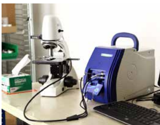
iRaman Pro avec opton microscope
