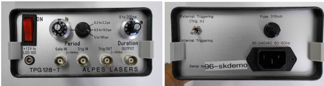
Figure 1.12.: TTL Pulse Generator (TPG).
