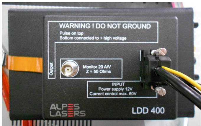
Figure 1.11.: Laser Diode Driver (LDD).
